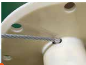
將鋼索檔頭從左側放 入收線盤內側孔固定
