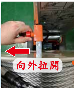
定位珠向外拉開，收線盤放入 孔內，確認固定後才可拉線
