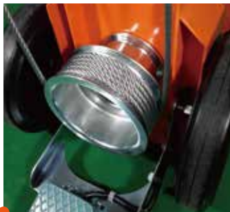
鋼索以順時鐘方向纏入 外圈 5圈(含) 以上，拉力 不足時請使用內圈，可 提升拉力
